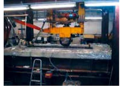
連続桁負曲げ輪荷重走行実験（大阪大学）
