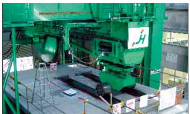
移動載荷疲労試験 (施工技術総合研究所)
