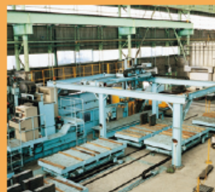
●全自動NC孔明機 New NC Drilling Machine
