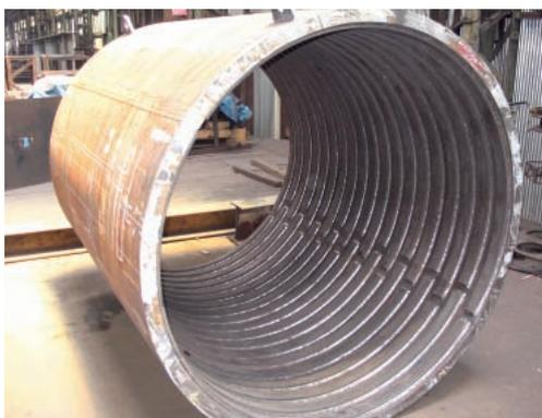
写真-2 内面ずれ止め溶接・外面罫線
