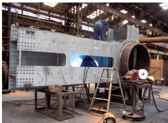
写真-10 箱形大梁仕口の溶接
