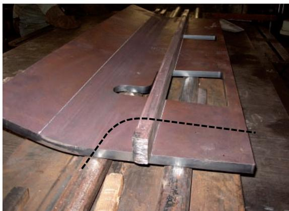
写真-8 舌板曲げ試験（切断順序の決定）
