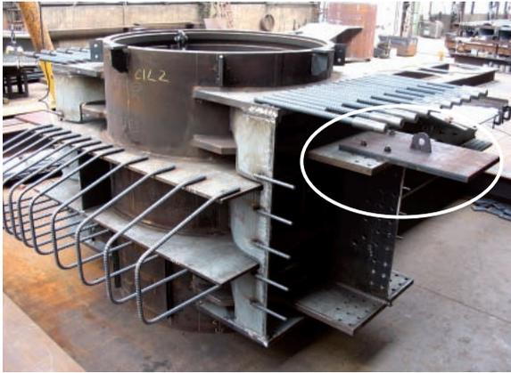
写真－11 舌板と主筋の組立・溶接
