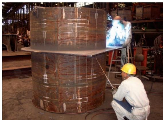
写真-5 Jリングの溶接と矯正
