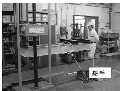
写真-1 継手部の試験状況
