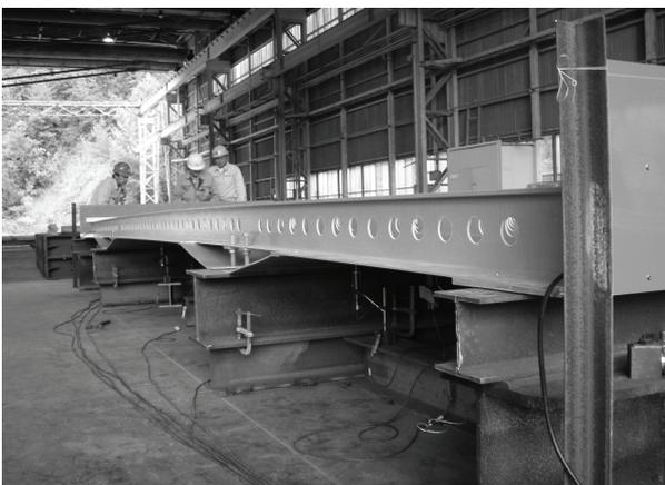
写真-6 強制変位載荷時の状況
