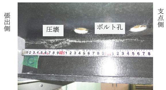
写真-2 ウェブAの損傷状況（水平載荷）
