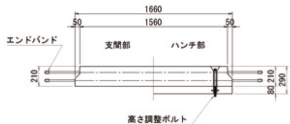
図-8 プレキャストRC床版構造図
