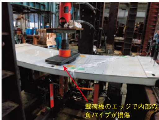
図-24 ③試験体の破壊時の状況
