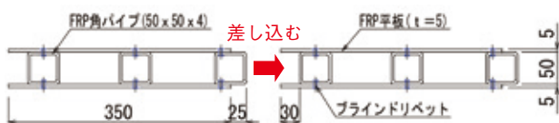
図-2 渡し板の断面形状
