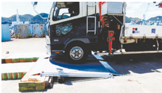
図-5 载荷試験状況
