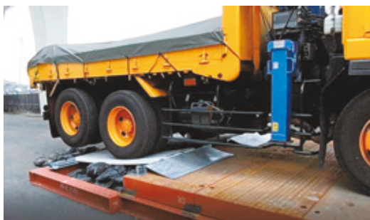
図-18 渡し板単体での走行試験状況
