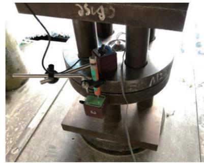
写真-1 引張試験治具
