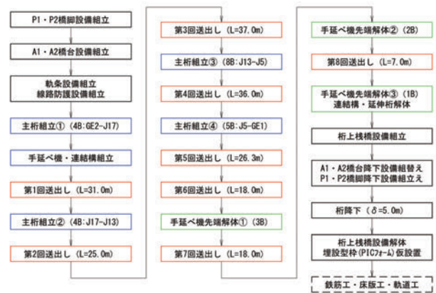
図-4 施工フロー
