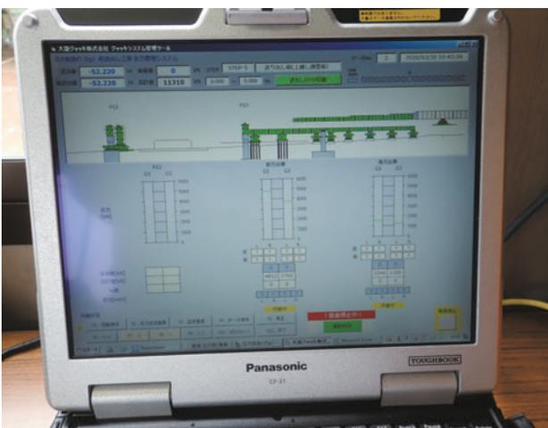
写真-23 ジャッキ反力計測
