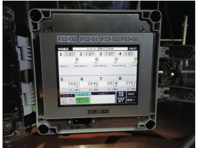
写真-29 デジカジプラス（降下量計測管理）
