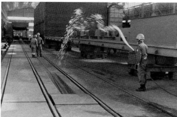
写真3 厚膜無機ジンクの塗装(散水)
