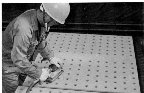
写真-2 接合面のサンダー削り
