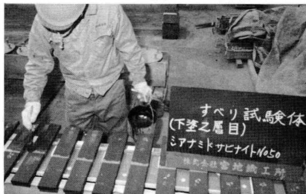
写真-2 塗装状況(鉛系サビ止め)
