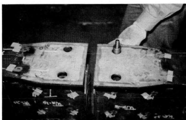
写真-8 ピン孔の塑性変形
