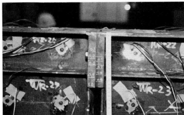
写真-5 支圧・ピン継手支圧部の肌すき（右）
