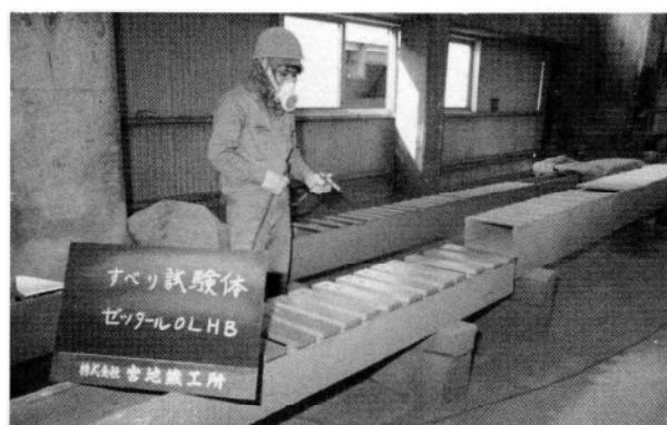
写真-1 塗装状況(厚膜型無機ジンクリッチャペイント)
