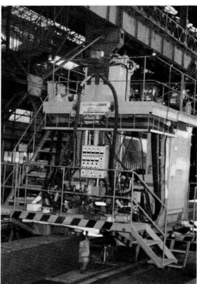
写真-5 ポックス柱シーム溶接装置
