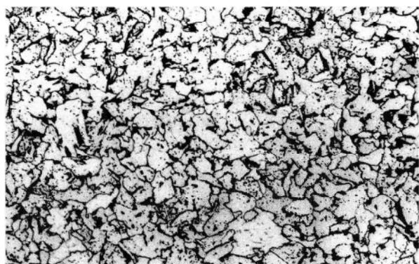
写真-3 顕微鏡組織 (HAZ部 2 mm)
