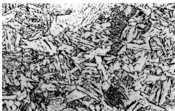
写真-2 顕微鏡組織 (HAZ部 1 mm)
