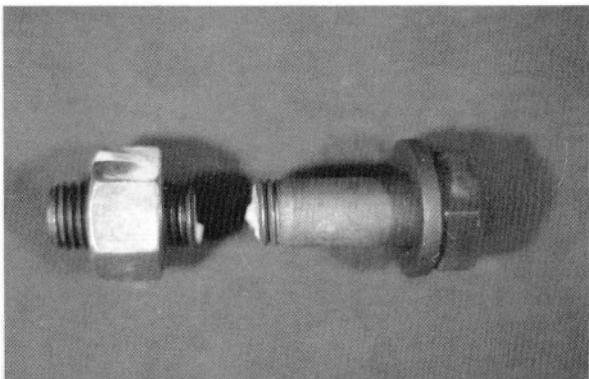
写真-3 破断高力ボルト
