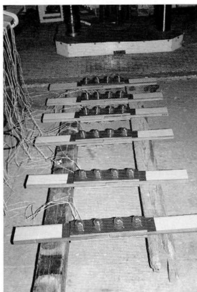
写真-2 試験体継付後
