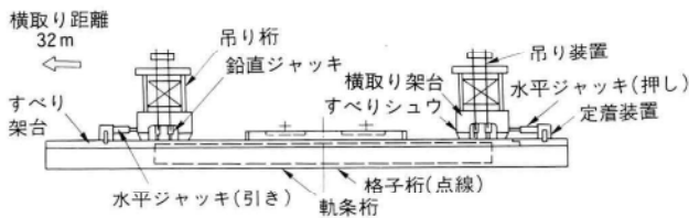
図-4(b) 桁横取り段取りの断面図
