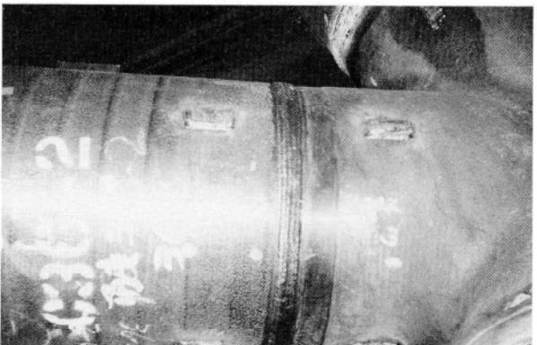
写真-3 試験体溶接完了状況
