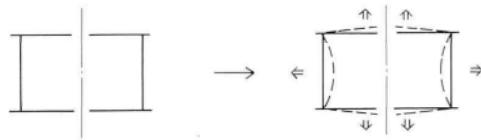
図-7 めっきによる変形
