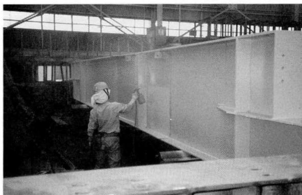
写真-5 大型供試体塗装
