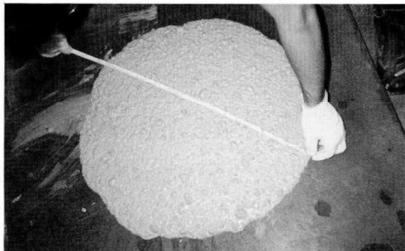
写真-1 スランプフローの測定
