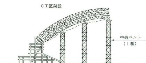
図-9 架設ステップ図
