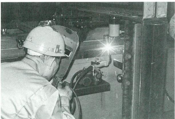
写真-4 コ組立時の自動仮付け・シーリング溶接状況の一例
