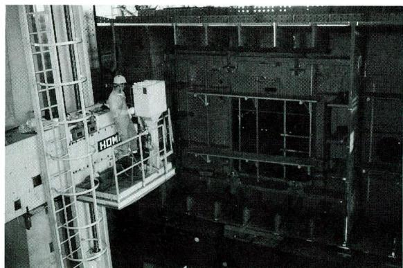
写真-I 塔柱の端面切削
