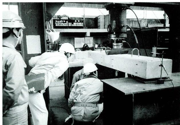
写真-2 継手構造耐力試験状況
