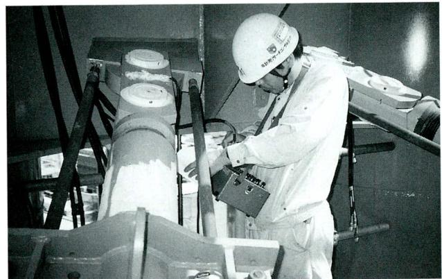
写真-7 ひずみゲージ計測状況
