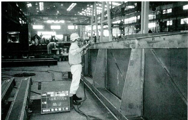
写真-2 上弦リブ・フレーム製作状況
