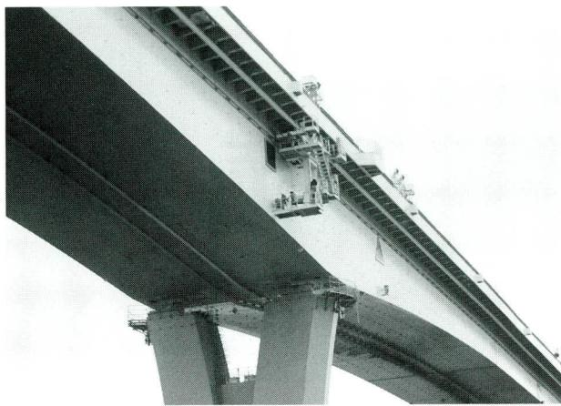
写真-6 東京湾アクアライン橋梁点検車（側面）
