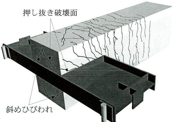
図-8 接合部の押し抜きせん断破壊
