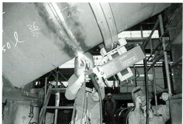
写真-1 SY-ROBO W3800による鋼管全周溶接
