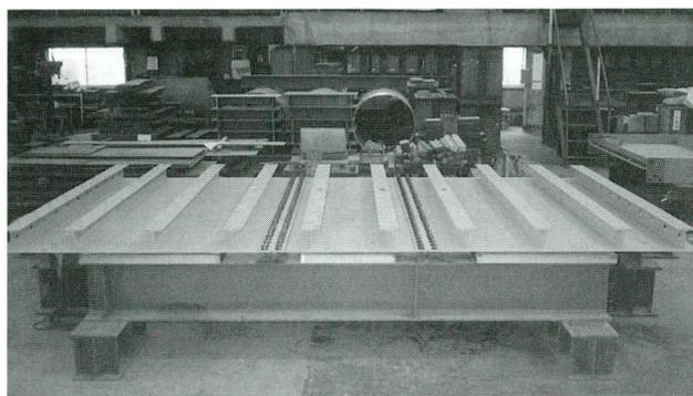
写真-3 底鋼板組立後
