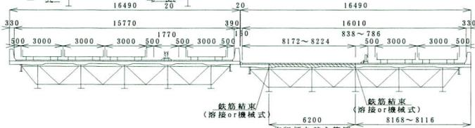
図-3 レーンごとの床版打ち替え方法
