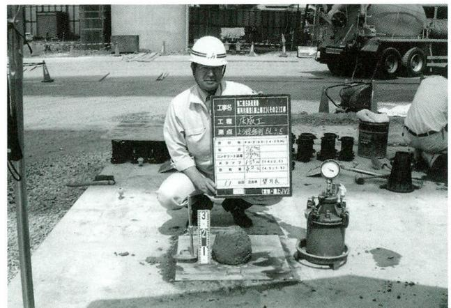
写真-45 荷卸し時のコンクリート性状
