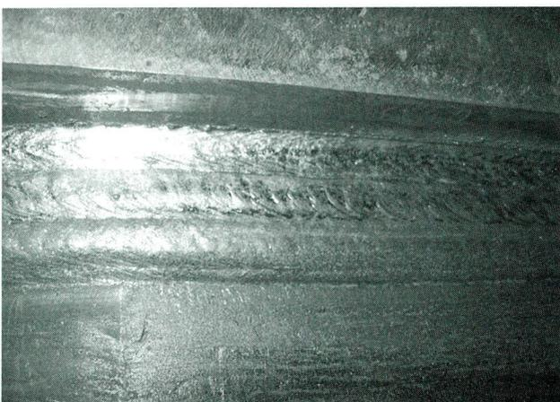
写真-10 NBFW 法溶接外観
