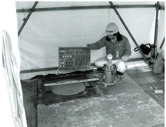
写真-8 コンクリート受入れ検査
