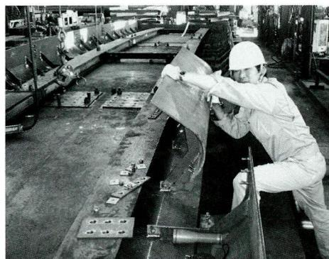
写真-3 可動式の側板
