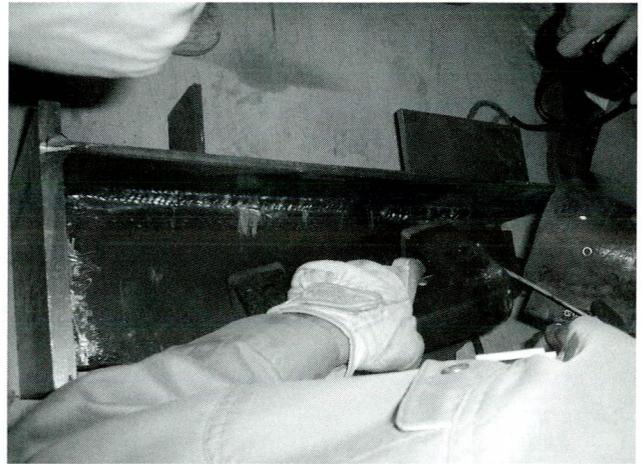
写真-7 磁粉探傷試験状況
