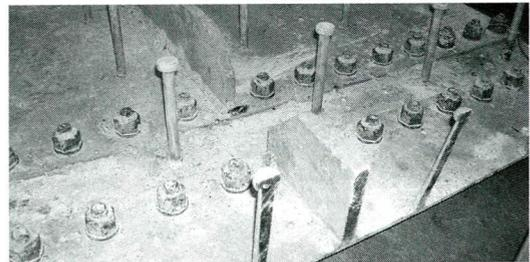
写真-8 試験終了後の鋼製パネル
