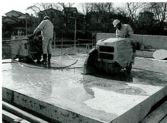
(e) 試験体の切断
