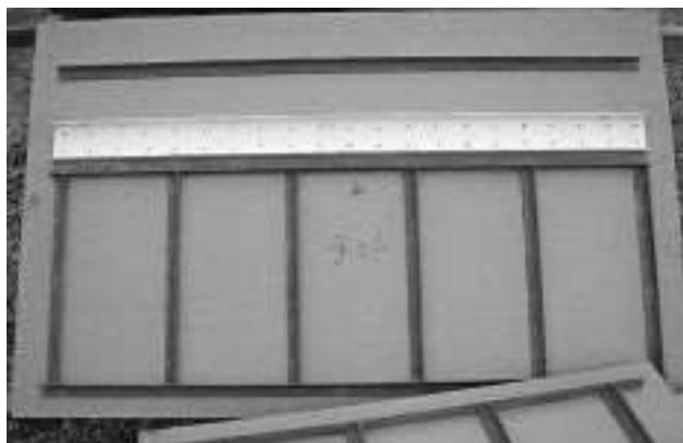
写真-4 主桁側板の補強構造
