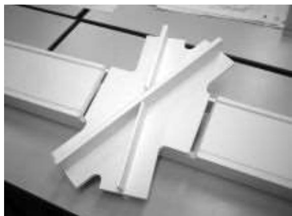
写真-1 溝形梁の模型（プレース交差部）
