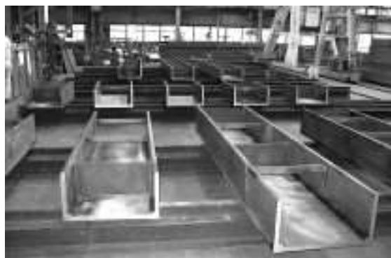
9～10mで製作しバンドソーで切断した状況
