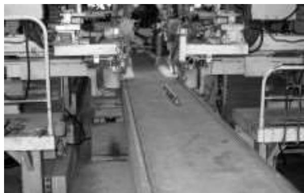
ツイン二電極サブマージ溶接の溶接状況
