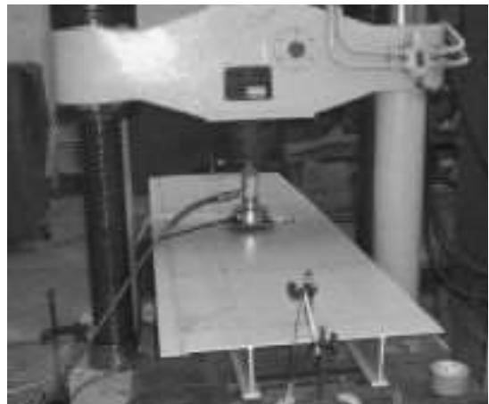
図-11 静的載荷試験状況(単体パネル)
