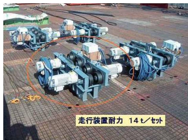
写真-9 移動防護工走行装置
