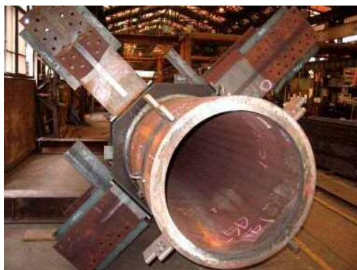
写真-11 梁仕口取付状況
