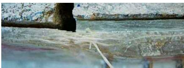
写真-8 添接板増厚部の破断状況
