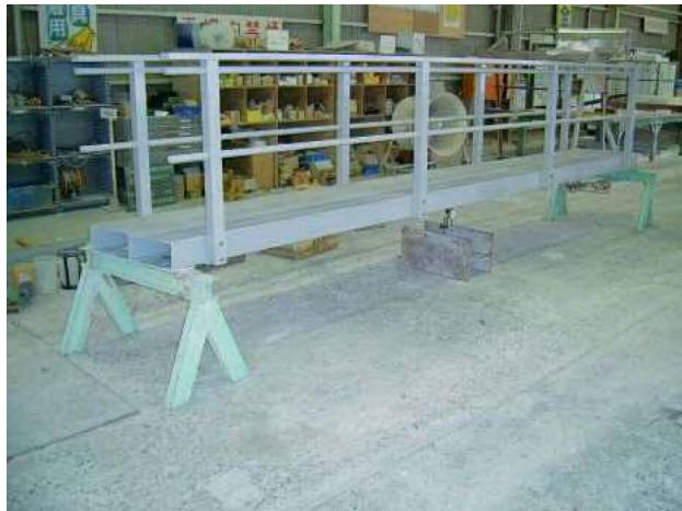
写真-1 6m級FRP検査路
