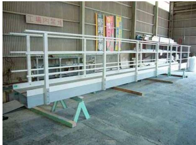
写真-2 10m級FRP検査路
