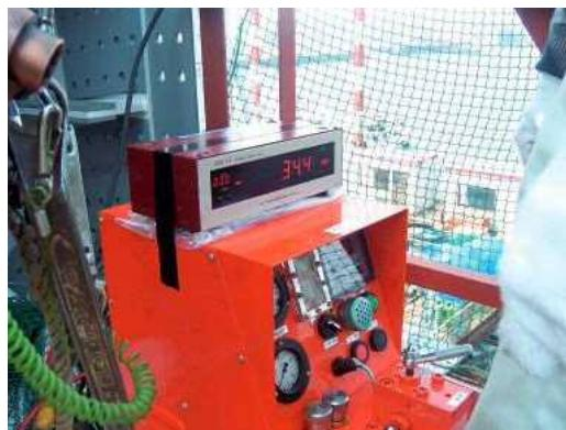
写真-2 ロードセル計測値とジャッキポンプ
