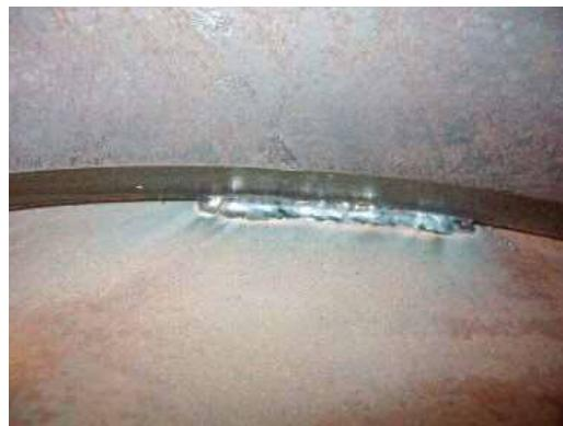
写真-7 組立溶接 (ルート間隔 1.5mm)
