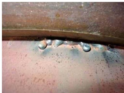
写真-8 組立溶接 (ルート間隔 3.5mm)
