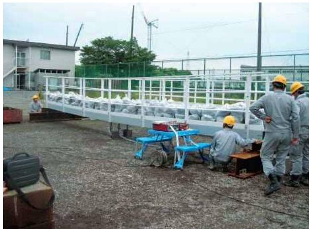
写真-3 鉛直荷重載荷試験
