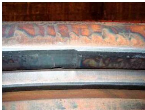
写真-1 ガス溶断加工
