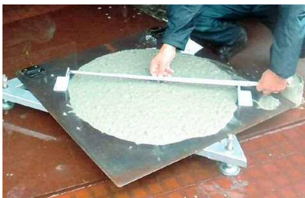
写真-4 スランプフロー試験
