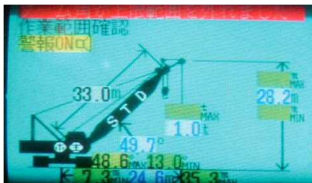
写真-4 クレーン起伏角度管理
