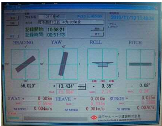
写真一10 架設桁姿勢監視システム
