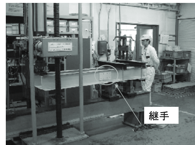
写真-1 継手部の試験状況
