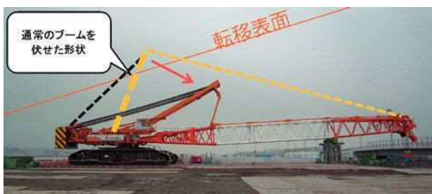
写真-3 750t吊クローラクレーン
