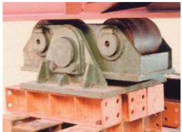
写真-11 送り出し用二軸ローラー
