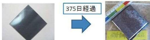
写真-2 鋼板試験片の腐食状況（カバー内）
