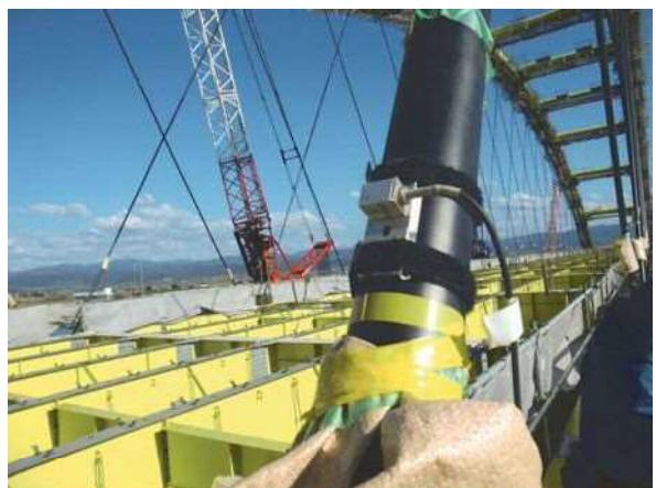
写真-10 ケーブル張力計測状況
