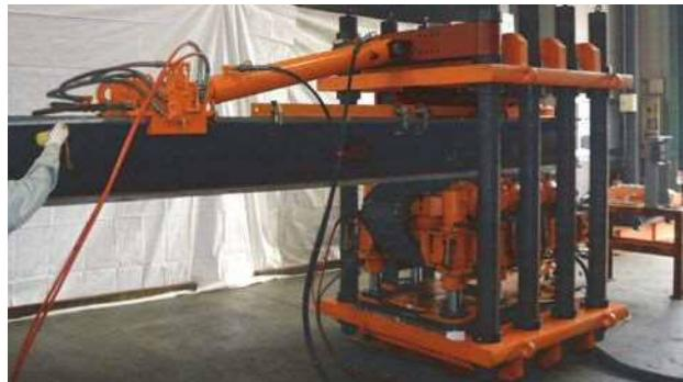
図-6 駆動シンクロジャッキ同調実験
