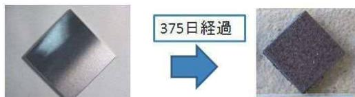
写真-3 鋼板試験片の腐食状況（鋼桁外）
