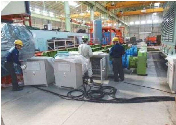
写真一3 自走台車空転試験状況
