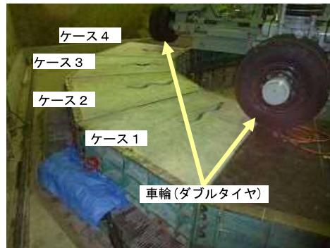
写真-6 試験機と供試体設置状況
