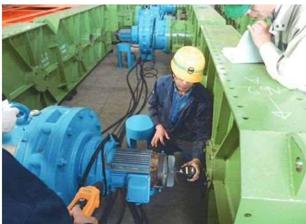
写真一4 モーターの回転数計測状況
