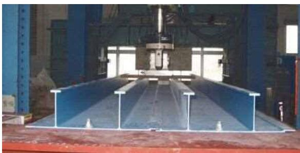
写真-4 FRP試験体設置状況
