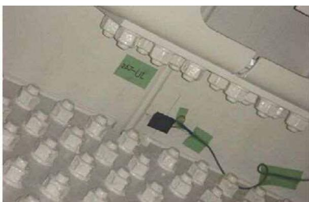
写真-4 ひずみゲージ設置状況
