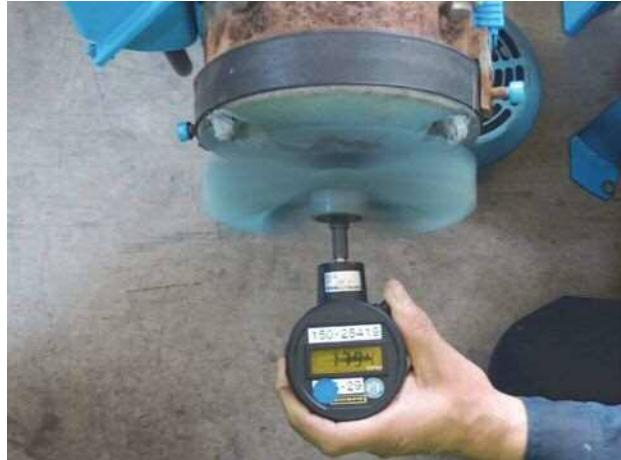
写真一5 モーターの回転数計測
