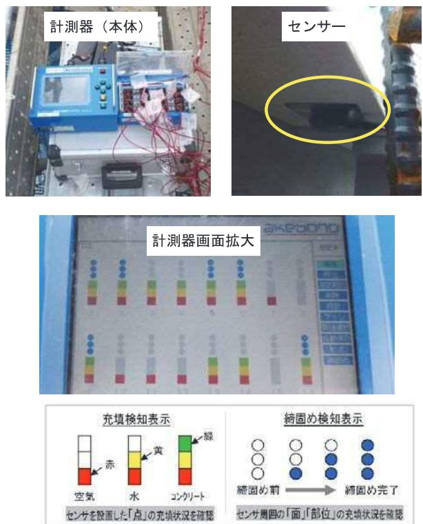
写真-6 ジュークエンダーによる計測
