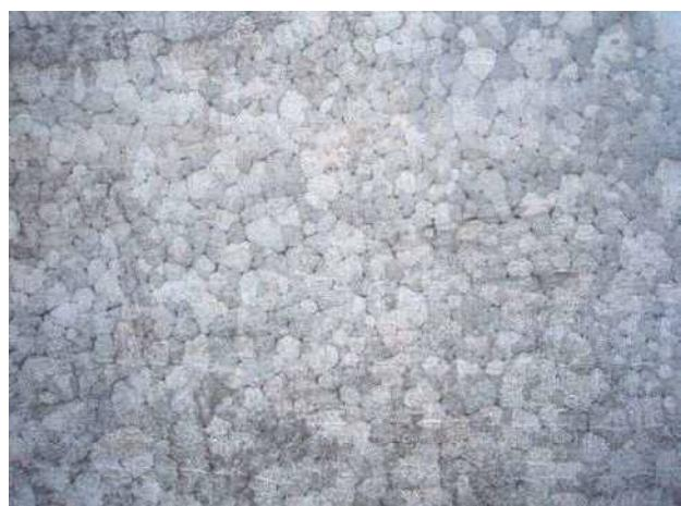
写真-5 溶融亜鉛めっき面の亀甲模様
