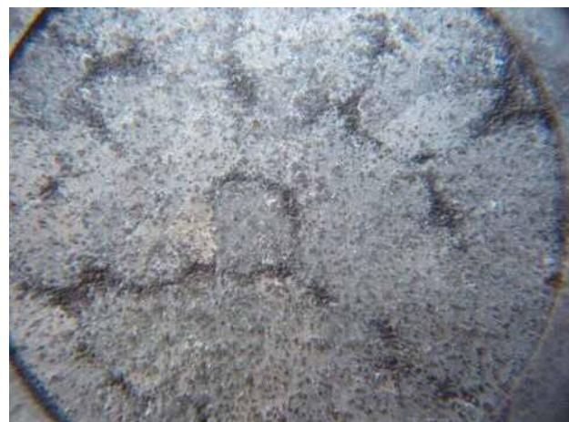
写真-6 溶融亜鉛めっき面の亀甲模様の拡大写真
