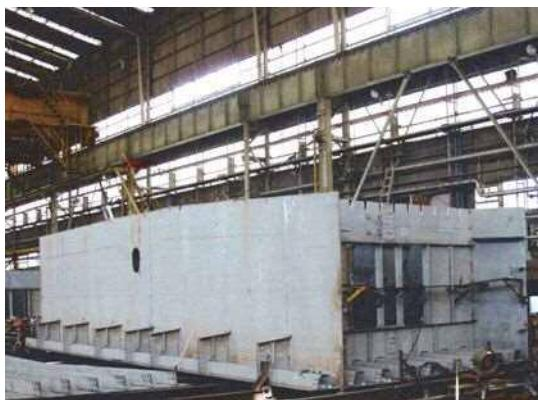
写真-1 箱桁の一体組立状況
