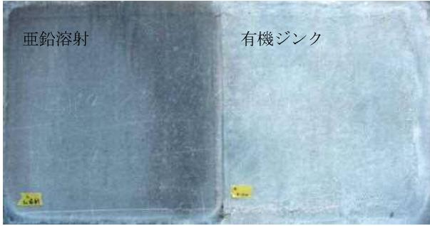
写真-2 溶射面の外観
