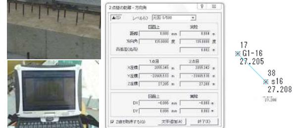
写真-2 トータルステーションによる計測
