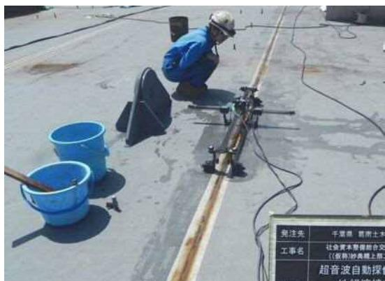
写真-5 デッキプレートの超音波自動探傷試験状況
