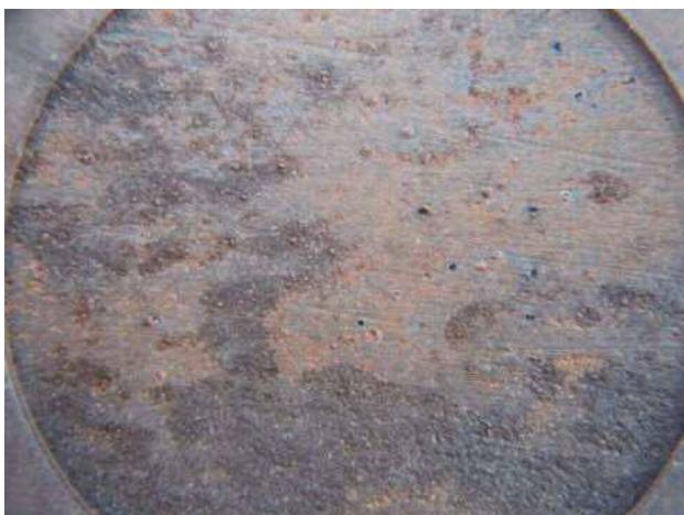
写真-4 溶融亜鉛めっき面の赤さびの拡大写真
