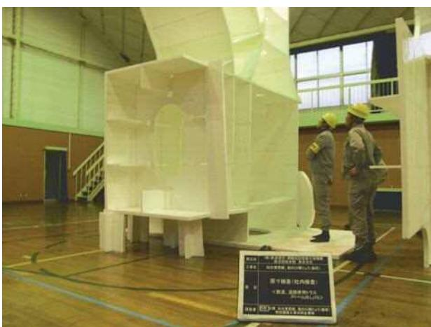
写真-3 格点部の実物大模型
