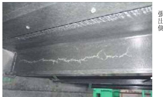
写真-3 ウェブAの損傷状況（鉛直載荷）
