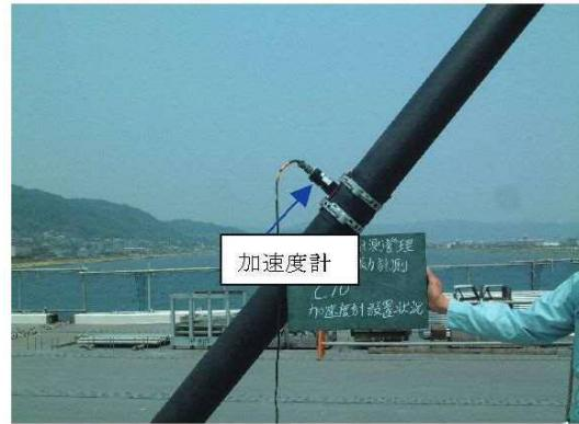
図-6 加速度計設置状況
