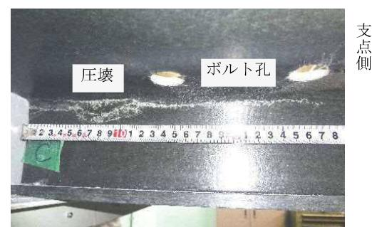
写真-2 ウェブAの損傷状況（水平載荷）
