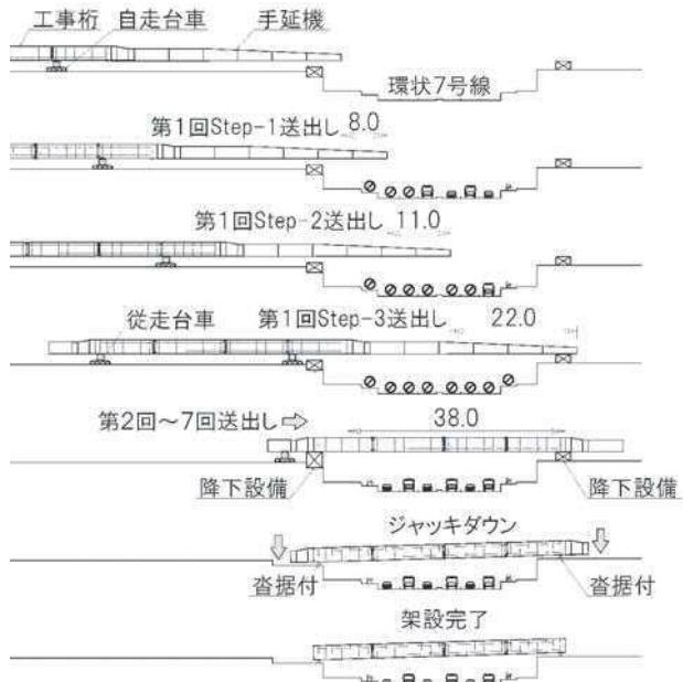
図一2 架設ステップ図
