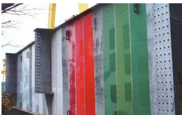
写真-1 実物大箱桁試験体の暴露状況
