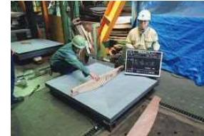
写真-2 バックルプレート検査
