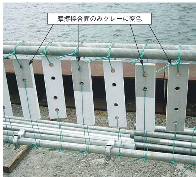
図-10 曝露中の試験体
