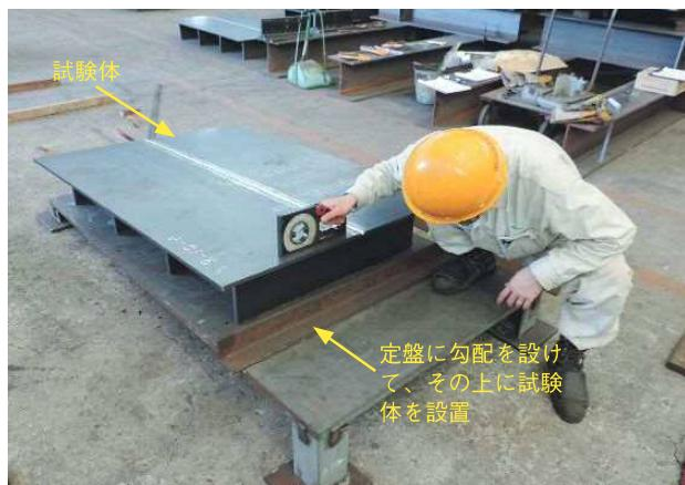
写真-1 試験体設置状況
