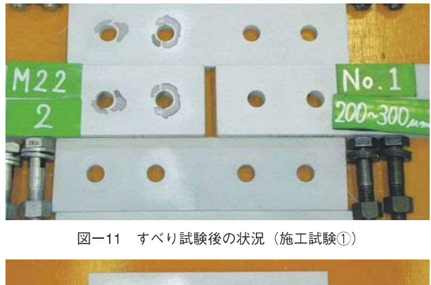
図-11 すべり試験後の状況（施工試験①）
