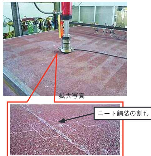
写真-6 試験状況（最大荷重21kN載荷時）
