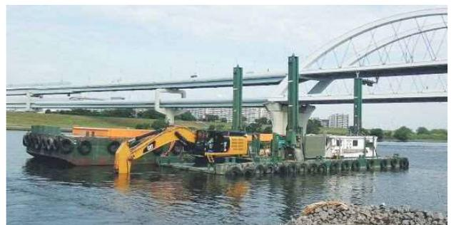
写真-5 バックホウ台船1m級
