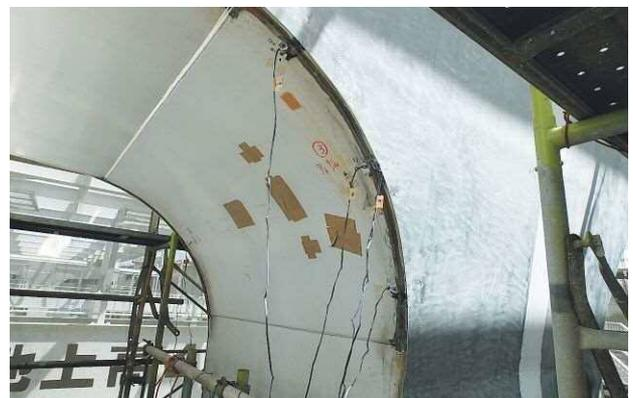
写真-11 ひずみゲージ取付状況
