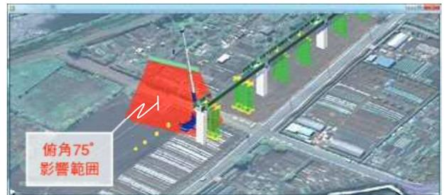
図-6 施工ステップ3（桁架設）
