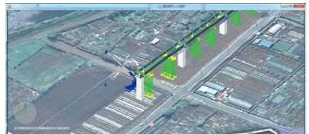
図-7 施工ステップ4（桁架設完了）
