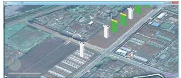
図-5 施工ステップ2（ベント設置）
