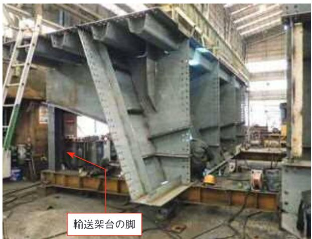
図-20 輸送架台④（溶接時）
