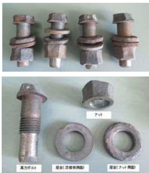
写真-2 高力ボルトの腐食状態
