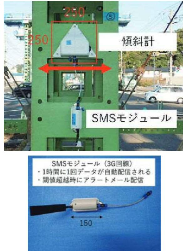
図-3 傾斜計およびSMSモジュール
