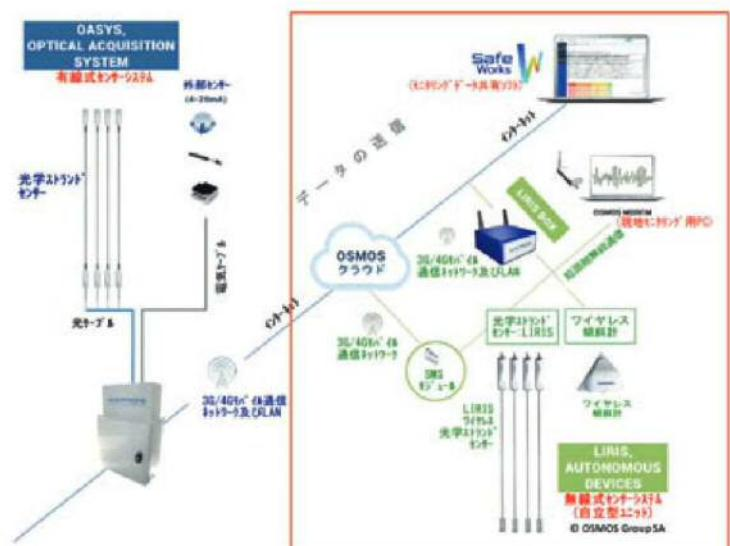
図-1 モニタリングシステム【OSMOS】の概要
