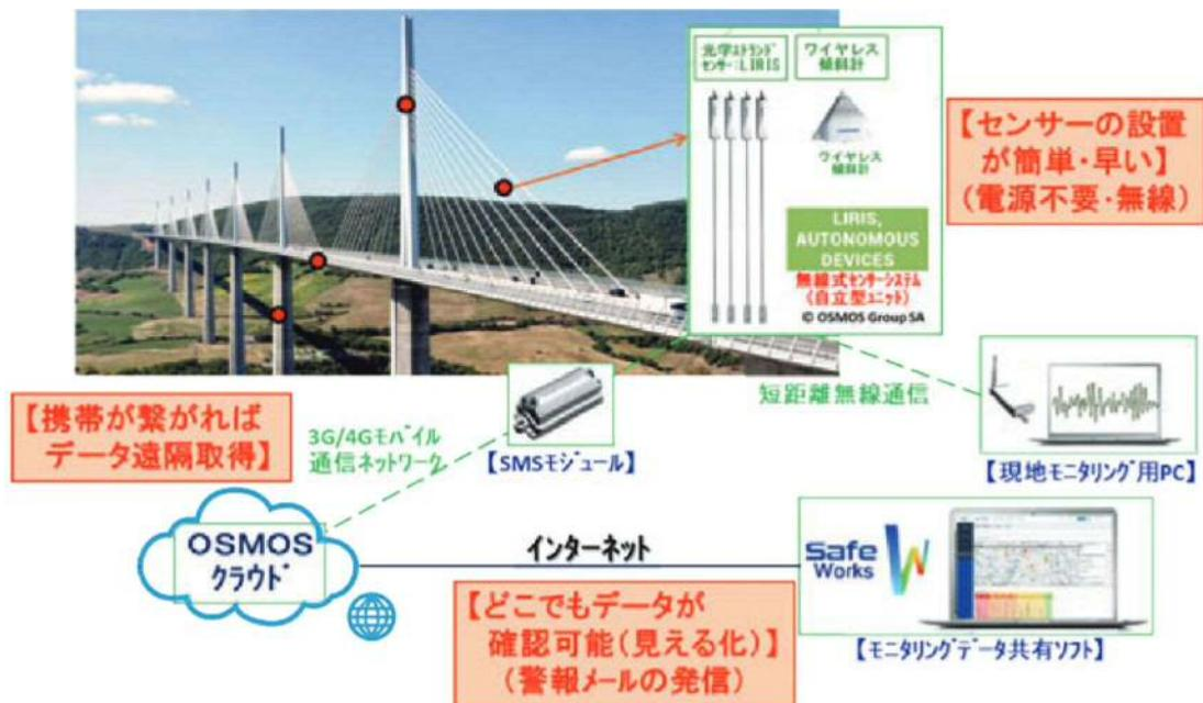
図-2 無線式センサーシステム：LIRISの概要と特徴
