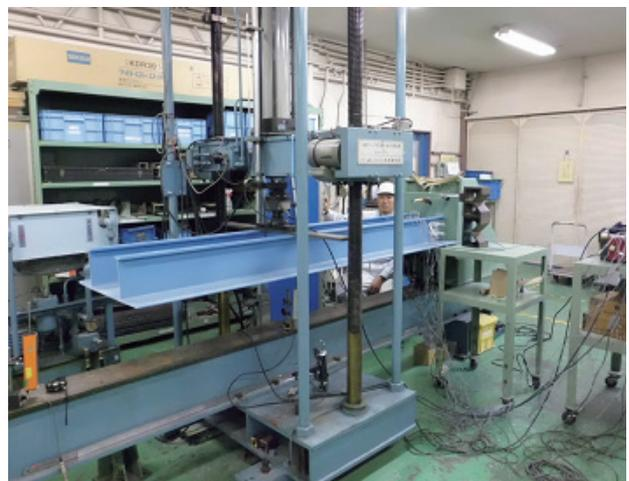
図-6 防風柵実験（前面載荷）の状況
