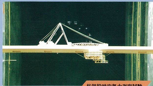
桁架設時空気力測定試験
