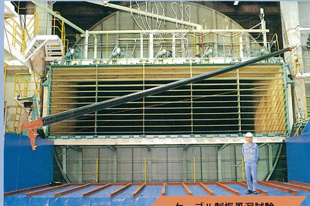
ケーブル制振風洞試験
