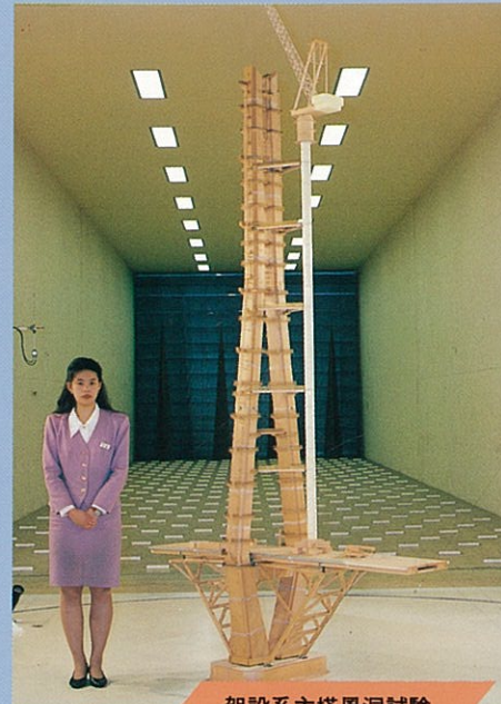
架設系主塔風洞試験
