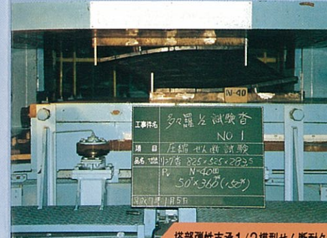
塔部弾性支承1/2模型せん断耐久試験
